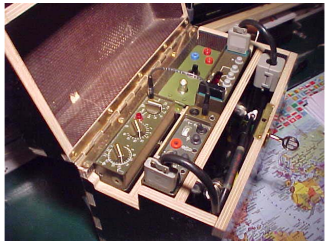
Abbildung 3, SP-20 mit S/E Umschaltung in Transportbox (nicht original) , im Stauraum ist Platz für alle Verbindungskabel einschließlich einer 20m LW-Antenne
