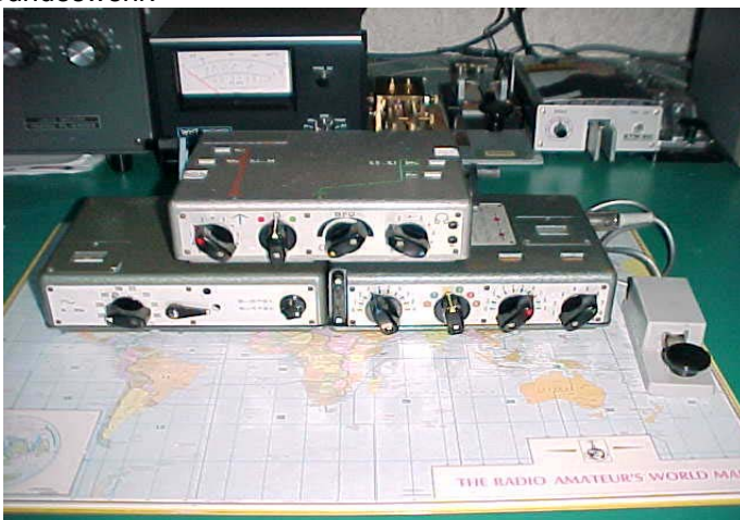
Abbildung 1, SP-15 Set mit original Morsetaste
